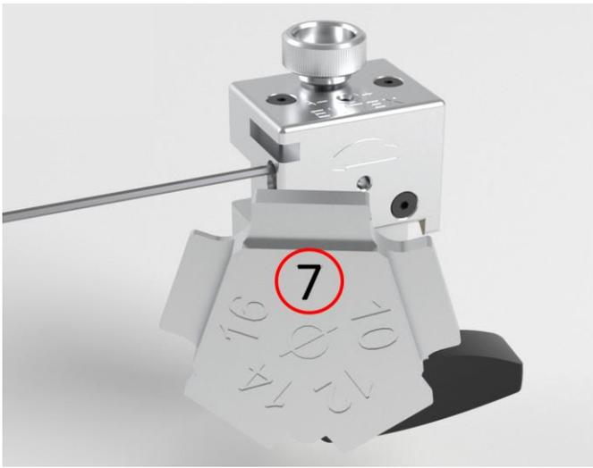
2.1.3 Aus der Werkzeugbox die Außenmaßstern entnehmen und diesen mit dem entsprechenden Außenmaß des Mikrorohres z.B. 7 mm einfügen.
